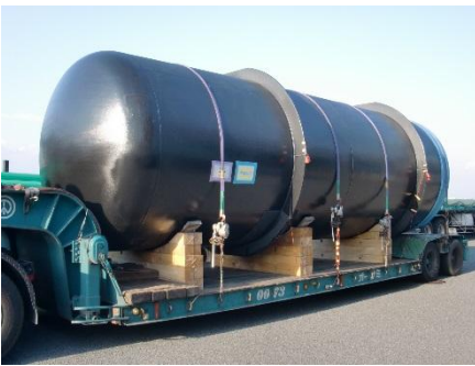
大型ボイラー輸送
